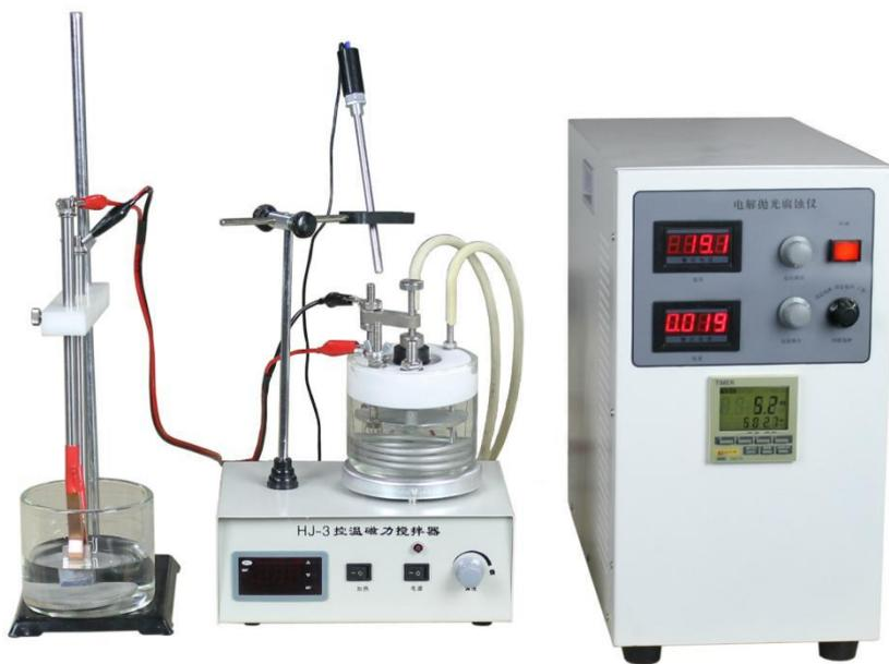
图 EP-06型 电解抛光腐蚀仪
